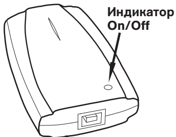
Вид сзади: разъем USB
