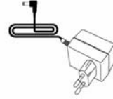
Fuente de alimentación para la estación base
