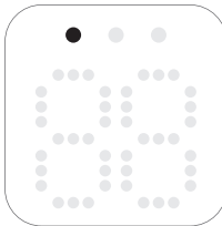
Првото светло е постојано вклучено. Батеријата е доволно наполнета за една сесија.*
