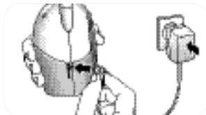
1 Collegate il cavo dell'alimentatore al jack di alimentazione (CC 9V  $\ominus$   $\oplus$  - A-3) dell'unità baby.
