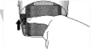
3 Deslice la tapa del compartimento para pilas (B-12) en su sitio hasta que quede bien encajada y, con un destornillador, cierre el compartimento.
