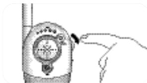
3 Slå på föräldraenheten med dess på/av-knapp (B-9) och justera volymen till önskad nivå med hjälp av volymkontrollen (B-9).
