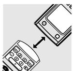
Om din utrustning inte finns med i kodlistan, eller om du saknar vissa koder från originalfjärrkontrollen, klarar SBC RU865 det också. Den kan kopiera och återskapa koder från originalfjärrkontrollen. Så här gör du: Placera originalfjärrkontrollen så att den är riktad mot IR-fönstret på SBC RU865. Lägg båda kontrollerna på en plan yta på 3–8 centimeters avstånd från varandra.
