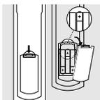
Για να χρησιμοποιήσετε το SBC RU865, θα χρειαστείτε τρεις μπαταρίες 1,5 V τύπου UM3, LR6 ή AA μόνο.
