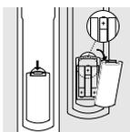
För att använda SBC RU865 behöver du tre 1,5 V batterier. Använd endast typ UM3, LR6 eller AA. Kom ihåg att byta batterier minst en gång om året. RU865 har den unika egenskapen att den inte förlorar inprogrammerade eller inlästa koder när batterierna tar slut. Vi rekommenderar att du använder Philips Longlife eller Powerlife-batterier.
