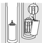
Voor de SBC RU865 hebt u drie batterijen van 1,5V nodig, type UM3, LR6 of AA. Vervang de batterijen minimaal één keer per jaar. De RU865 heeft een unieke functie die zorgt dat de geprogrammeerde of geleerde codes niet verloren gaan als de batterijen leeg zijn. We raden u aan Philips Longlife- of Powerlife-batterijen te gebruiken.
