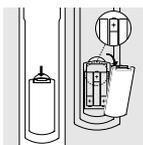
Pour le bon fonctionnement de la télécommande SBC RU865, vous devez utiliser trois piles 1,5 V de type UM3, LR6 ou AA uniquement. N'oubliez pas de remplacer les piles au moins une fois par an. La télécommande SBC RU865 présente l'avantage de ne pas perdre les codes programmés ou assimilés lorsque les piles sont usées. Nous vous recommandons d'utiliser les piles longue durée Philips Longlife ou Powerlife.
