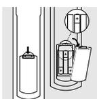
Für den Betrieb der SBC RU865 benötigen Sie drei 1,5 V-Batterien, aber nur vom Typ UM3, LR6 oder AA. Die RU865 besitzt die einzigartige Funktion, dass die programmierten oder erlernten Codes bei leeren Batterien nicht verloren gehen. Wir empfehlen, Philips Longlife- oder Powerlife-Batterien zu verwenden.
