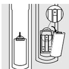
Para utilizar o SBC RU865, precisa de três pilhas 1,5V, tipo UM3, LR6 ou AA apenas.
