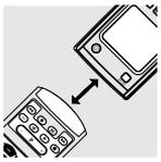
Se o equipamento não estiver incluído na lista de códigos ou se faltarem códigos específicos do telecomando, o SBC RU865 tem a solução. Pode copiar e reproduzir códigos do telecomando original. Eis como fazê-lo... Coloque o telecomando original virado para a janela do sensor de infravermelhos do SBC RU865. Coloque os dois telecomandos numa superfície plana, afastados entre si 3-8 centímetros.
