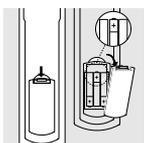
Para utilizar el SBC RU865 necesitará tres pilas de 1,5 V, tipo UM3, LR6 o AA. No olvide cambiar las pilas al menos una vez al año. El RU865 tiene la característica de que no perderá los códigos programados o copiados cuando las pilas estén gastadas. Le recomendamos que utilice pilas Philips Longlife o Powerlife.
