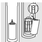
Per far funzionare il telecomando SBC RU865 sono necessarie tre batterie da 1,5V, tipo UM3, LR6 o AA. Ricordate di sostituire le batterie almeno una volta l'anno. L'esclusiva funzione implementata nel telecomando RU865 conserva i codici programmati o impostati anche a batterie scariche.
