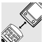
Hvis utstyret ditt ikke står på kodelistene, eller hvis det mangler spesifikke koder på fjernkontrollen din, kan SBC RU865 løse problemet. Den kan kopiere og gjengi koder fra den opprinnelige fjernkontrollen. Slik går du frem...Legg den opprinnelige fjernkontrollen slik at den vender mot det infrarøde sensorvinduet på SBC RU865. Legg begge fjernkontrollene på et flatt underlag, 3-8 cm fra hverandre.
