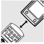
Als uw apparaat in de codelijst ontbreekt of als bepaalde codes op uw afstandsbediening ontbreken, dan biedt de SBC RU865 toch een oplossing. Hij kan namelijk codes vanuit uw oude afstandsbediening kopiëren en die zelf opslaan, dus nieuwe codes leren. Dit gaat als volgt...
