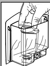
Introducir el filtro en el depósito vacío. Presionar hasta el tope.
