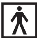
Dette symbolet betyr: Philips BlueControl er en bruksdel av typen BF. B (Body) angir at enheten brukes på kroppen, og F (Floating) at enheten er ujordet (ikke koblet til nettspenning).
