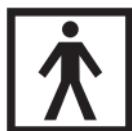
Dit symbool betekent: Philips BlueControl is geklassificeerd als een onderdeel van type BF. B geeft aan dat het op het lichaam wordt gebruikt (Body) en F geeft aan dat het los staat van (niet is aangesloten op) de netspanning (Floating).
