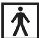
Den här symbolen betyder: Philips BlueControl anges som tillämpad del av typen BF. B anger att den används på kroppen och F anger att den är flyttande från (ej ansluten till) nätspänningen.
