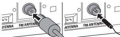
*Nota: Si está usando un sistema de cable de antena o una antena exterior, introduzca la clavija de la antena en FM ANTENNA en lugar de la antena de hilo.*
