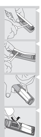
7 在多个部位将螺丝刀插入电路板的下面。
