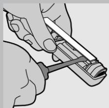
**6** 在多个部位将螺丝刀插入电路板的下面。
