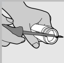
**4** 向一侧旋转螺丝刀柄，使用扭摆的动作沿牙刷柄的侧接处响的一声将其打开。
