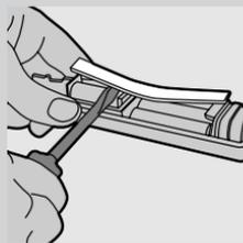
**7** 扳動或搖動電路板使其鬆動，直到可將電路板完全從候把卸下。
