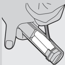
**8** 將螺絲起子從 2 顆 AA 尺寸的鹼性電池旁插入 (如下圖所示)，將電池撬開。
