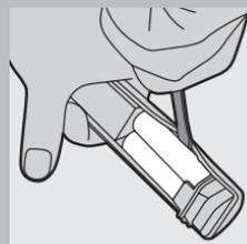
**8** 在图示的位置沿两节电池的各边插入螺丝刀，将两节 AA 尺寸镍镉镍电池提松。
