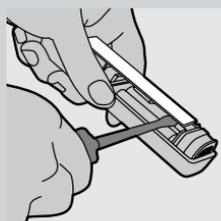
**6** 從多處將螺絲起子插入電路板下。
