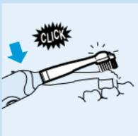
**1** Die Druckkontrolle (das Gum Protection System) verhindert, dass Sie bei der Zahnpflege mit der Bürste einen zu starken Druck auf Zähne und Zahnfleisch ausüben.
