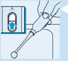
**6** Dorong alat sorong pada pegangan alat ke atas untuk mengalirkan air.
