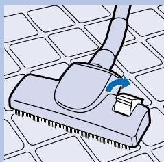
Die Universaldüse lässt sich auf Hartboden und auf textilem Bodenbelag verwenden.
