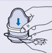
**3** Drücken Sie den Ring zur Befestigung des Staubbeutels wieder hinunter.
