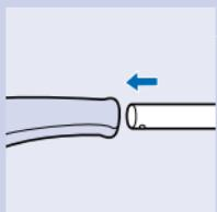
**1** Μπορείτε να συνδέσετε το ρύγχος όταν καθαρίζετε σκληρά δάπεδα, χαλιά και επιφάνειες που δεν μπορείτε να φτάσετε εύκολα. Σπρώξτε το στενό τμήμα του ρύγχους μέσα στην οπή της χειρολαβής μέχρι να ακούσετε ένα κλικ.
