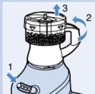
**6** Cuando hayan acabado el picado, paren el aparato, desenchúfenlo de la red y desmonten el accesorio Picador haciéndolo girar en la dirección de la flecha.
