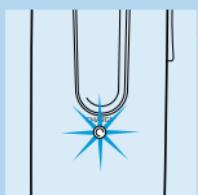
► La lámpara piloto verde se encenderá para indicar que el aparato está cargándose. Necesitará aproximadamente 1 hora para cargar completamente la batería. La lámpara piloto parpadeará para indicar que la batería está completamente cargada.
