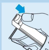
Poderá, então, voltar a colocar o pente acessório na máquina.
