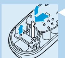
**4** Infilate il cacciavite nella piccola fessura del circuito stampato contraddistinta da una freccia. Spingete il cacciavite fino a quando si romperà una parte del circuito stampato.
