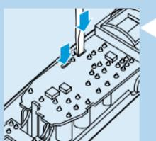
**3** Separate le due parti della custodia usando un cacciavite.
