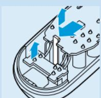
**4** Steek de schroevendraaier in de kleine opening in de printplaat die gemarkerd is met een pijl. Druk de schroevendraaier omlaag totdat er delen van de printplaat afbreken.
