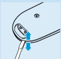
**2** Draai de schroef in het trimmerhuis los.
