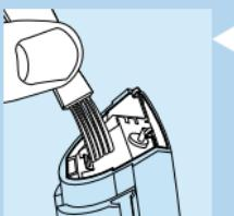
**4** Jedinicu rezača, kao i unutrašnjost uređaja, čistite isporučenom četkom.
