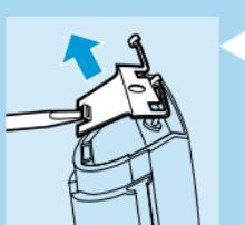
**3** Z izvijačem odstranite kovinski zatič.
