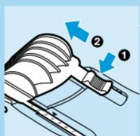
**1** Nastavek odstranite tako, da pritisnete nastavitevni gumb na hrbtni strani aparata in nastavek potisnete do končnega položaja.
