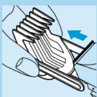
**1** Перед початком чищення впевніться, що прилад вимкнено та від'єднано від електромережі.
