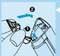
**5** Přístroj složte tak, že do přístroje vložíte zpět stříhací jednotku.
