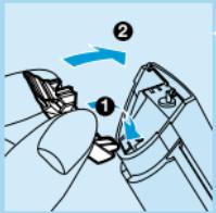
**5** A hajnyíró összeszerelésénél akassza a vágóegység kapcsait a burkolatba.
