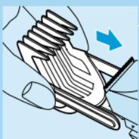
**2** Apăsați butonul de reglare din spatele aparatului și poziționați pieptenele de frezat pe poziția dorită (a se vedea tabelul).
