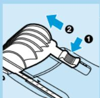
**1** Pentru a scoate pieptenele de frezat, apăsați butonul de reglare din spatele aparatului și fixați pieptenele pe poziția finală.
