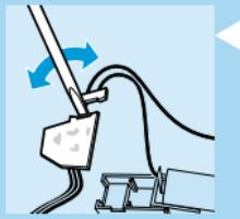
**6** Vstavite izvijač v majhno režo na plošči s tiskanim vezjem, ki je označena s puščico. Pritisnite izvijač navzdol, tako da se del tiskanega vezja odlomi.
