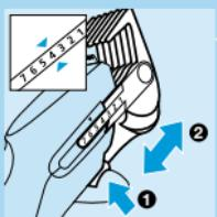
**3** Dați drumul butonului de reglare pentru a fixa pieptenele de frezat.
