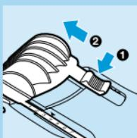
**1** Hřebenový nástavec sejměte tak, že stisknete zajišťovací tlačítko na zadní stěně přístroje a nástavec posunete do jeho koncové polohy.
