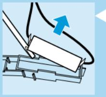
**7** Z izvijačem ločite baterijo od plastičnega dela.
