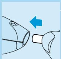
**1** Zasuňte zástrčku sítového přívodu do přístroje.
