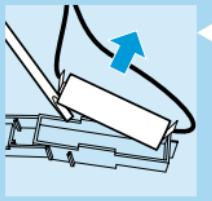
**7** Odvijačem odvojite bateriju od plastičnog dijela.
