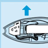
**5** Vysuňte z přístroje držák akumulátoru.
