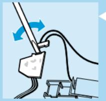
**6** Umetnute odvijač u mali utor ploče s kontaktima označen strelicom. Pritisnite odvijač dok se dio ploče s kontaktima ne polomi.
