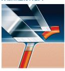
飞利浦剃须刀的双层刀片系统: 第一层刀片先将胡 须提起,再由第二层刀片将其剃去,使剃须贴面舒 适。
