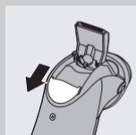
**1** Отворете машинката за подстригване чрез избутване на пъзгача надолу.
