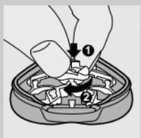
**4** Tag skærene ud og sæt nye i, således at fladen med de små huller vender ind mod skærhovedets midte.
