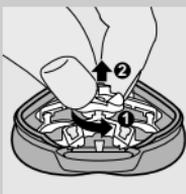
**1** Öffnen Sie die Schereinheit, drehen Sie das Rädchen gegen den Uhrzeigersinn (1) und entnehmen Sie den Scherkopfhalter (2).
