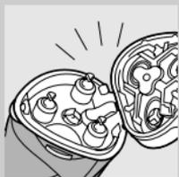
**6** Öffnen Sie die Schereinheit, und lassen Sie sie offen, bis das Gerät völlig trocken ist. Sie können die Bartfangkammer mit Hilfe der beiliegenden Bürste auch ohne Wasser reinigen.
