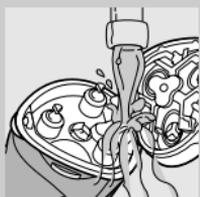
**3** Reinigen Sie Schereinheit und Bartfangkammer, indem sie beide eine Weile unter heißem Wasser ausspülen.
