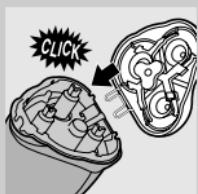
vaurioita. Jos jousisarana on kunnolla kiinni, ajopää on helppo laittaa takaisin paikalleen. Jos taas jousisarana on irronnut, haljennut tai vaurioitunut, ota yhteys Philips-myyjään tai Philips Kodinkoneiden valtuuttamaan huoltoliikkeeseen, ettei itse laite vahingoitu.
