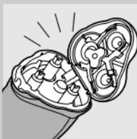
**5** Öffnen Sie die Schereinheit und lassen Sie sie offen, bis das Gerät völlig trocken ist. Sie können die Bartfangkammer mit Hilfe der beiliegenden Bürste auch ohne Wasser reinigen.
