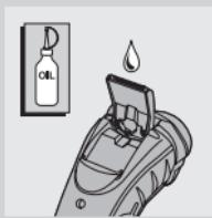
**3** ทุกๆ หกเดือน ควรหยดน้ำมันจักรเพื่อหล่อลื่นชิ้นส่วนของที่กันจอน
