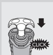
**1** Priključite utikač uređaja na aparat za brijanje.
