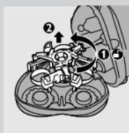
**1** Otvorite jedinicu za brijanje, okrenite kvačicu za zaključavanje u smjeru obrnutom od smjera kazaljke na satu (1) i izvadite okvir za pričvršćivanje (2).
