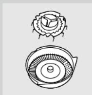
**2** Očistite rezače i štitnike priloženom četkicom. Nemojte istovremeno čistiti više od jednog rezača i štitnika jer su međusobno usklaćeni. Ako ih slučajno pomiješate, možda će trebati nekoliko tjedana prije uspostavljanja ponovnog optimalnog rada aparata.
