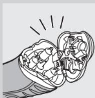
**5** Ponovno otvorite jedinicu za brijanje i ostavite je otvorenom kako bi se aparat u potpunosti osušio.
