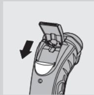
**1** Odprite rezilo s potiskom drsnika navzdol.
