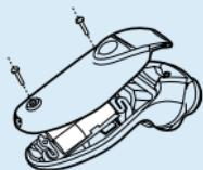
**2** La maskinen gå til den stopper, skru ut skruene og åpne maskinen.
