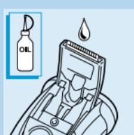
**3** 每隔六个月用一滴缝纫机油润滑修剪器的剪齿。
