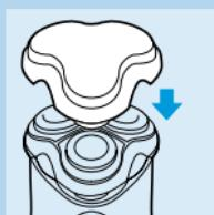
■ 將電鬍刀保護蓋蓋上以預防損傷。
