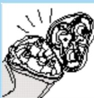
**3** Iztīriet skūšanas bloku un matu nodalījumu, kādu laiku skalojot tos zem karsta krāna ūdens ( $60\text{--}80\text{ }^{\circ}\text{C}$ ).
