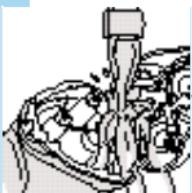
Operite reznu jedinicu i spremnik za dlačice pod vrućom vodom ( $60^{\circ} - 80^{\circ}$  C).
