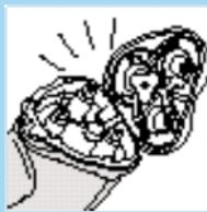
**3** Очистите бритвенный блок и камеру волососборника, промывая их под горячей водопроводной водой ( $60-80\text{ }^{\circ}\text{C}$ ).
