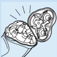
**3** Reinigen Sie die Rasiereinheit und die Bartfangkammer, indem Sie sie eine Weile unter heißem Wasser ausspülen.
