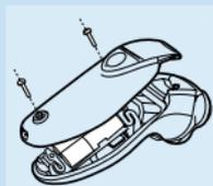
**2** Lassen Sie den Rasierapparat laufen, bis der Motor anhält, drehen Sie die Schrauben heraus und öffnen Sie den Rasierapparat.
