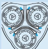
**3** Rode o anel para a esquerda e retire a armação.
