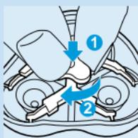
**4** Remova as cabeças de corte e coloque as novas na máquina, de maneira que os lados que têm os pequenos furos fiquem virados para o centro da unidade de corte.
