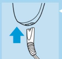
**1** Enchufe la clavija correspondiente a la afeitadora introduciéndola hasta la línea.
