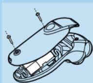
Het apparaat mag niet meer op netspanning worden aangesloten nadat de accu's verwijderd zijn.
