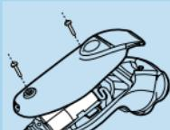
A máquina de barbear não deverá ser ligada novamente à corrente depois de retiradas as baterias.
