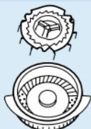
► Vratite učvrsnu pločicu natrag na brijaću jedinicu.
