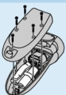
**1** Lassen Sie den Rasierer laufen, bis der Motor stoppt. Lösen Sie dann die Schrauben und öffnen Sie den Rasierer.
