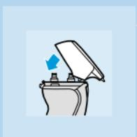
**4** Fjern trimmeren ved å trykke på utløserknappen igjen og trekke den av barbermaskinen.
