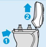
**2** Drücken Sie den Entriegelungsknopf, um die Schereinheit zu öffnen. Ziehen Sie die Schereinheit vom Gerät ab.
