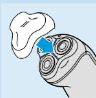
Ta ut patronen och rengör rakapparaten om du inte tänker använda den igen inom en vecka. Skölj rakapparaten efter varje rakning.
