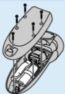
**1** Lassen Sie den Motor des Rasierers laufen, bis er stillsteht, lösen Sie dann die Schrauben und öffnen Sie den Rasierer.
