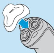
Togliete la cartuccia e pulite il rasoio se pensate di non usare l'apparecchio per più di una settimana. Risciacquate il rasoio dopo ogni rasatura.
