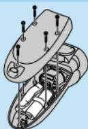
**1** Lassen Sie den Motor des Rasierers laufen, bis er stillsteht, lösen Sie dann die Schrauben und öffnen Sie das Gerät.
