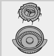
► Retire as cabeças velhas da máquina e substitua-as por novas.
