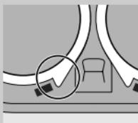
**5** Volte a colocar a armação na unidade de corte, faça pressão sobre o anel e rode-o para a direita.
