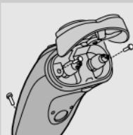
**2** Lassen Sie den Motor des Rasierers laufen, bis er stillsteht, drehen Sie dann die Schrauben heraus und öffnen Sie das Gerät.
