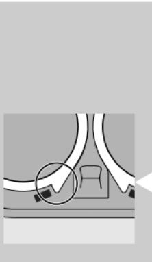
**5** Vuelva a colocar el marco de retención en la unidad afeitadora. Presione la ruedecita y gírela en el sentido de las agujas del reloj.
