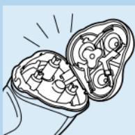
**3** Brijaću jedinicu i komoru za dlačice isperite pod vrućom vodom.
