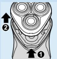
**3** Duw de ontgrendelknop in en neem de scheerunit van het apparaat.
