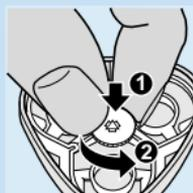
**3** Faites tourner la molette dans le sens contraire des aiguilles d'une montre et enlevez le cadre de retenue.
