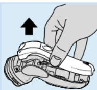
**2** Desconecte de la red eléctrica. Deje la maquinilla encendida hasta que se pare, afloje los tornillos y abra la maquinilla.
