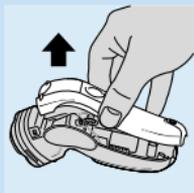
Dopo la rimozione delle batterie non è più possibile collegare l'apparecchio alla rete.
