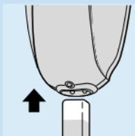
**1** Steek het apparaatstekkertje in het apparaat.
