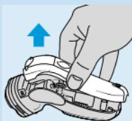
**2** Deixe a máquina funcionar até parar, desaperte os parafusos e abra-a.
