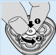
**2** Retire a unidade de corte da máquina.
