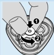
**3** Ruotare la rotella in senso antiorario e rimuovere il telaio di fissaggio.
