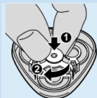
Se necessario, pulire l'unità di rasatura servendosi di una soluzione sgrassante (ad esempio alcool). Dopo la pulizia, ricordare di lubrificare il punto centrale della griglia con una goccia di olio per macchina da cucire.
