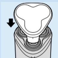
**4** Coloque la tapa protectora sobre la afeitadora para evitar que se deteriore.
