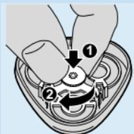
corte com um pouco de líquido desengordurante (álcool, por exemplo). Antes de terminar, não se esqueça de lubrificar o centro das protecções com uma gota de óleo para máquinas de costura.
