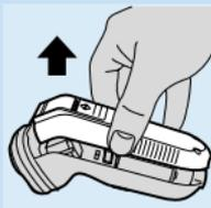
Der Rasierapparat darf nach Entnahme der Akkus nicht wieder ans Netz angeschlossen werden!
