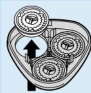
**4** Retire e limpe as cabeças de corte (lâmina e protecção), uma a uma.
