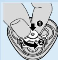
**3** Faites tourner la molette dans le sens inverse des aiguilles d'une montre et enlevez le flasque.
