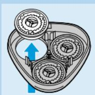
**4** Nehmen Sie jeweils nur einen Scherkopf heraus und reinigen Sie Schermesser und Scherkorb. Setzen Sie ihn wieder ein, bevor Sie den nächsten Scherkopf reinigen.
