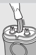
**4** Oczyść szczoteczką wnętrze elementu golącego oraz komorę na włosy.
