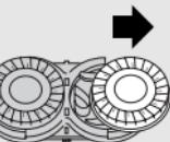
**3** Aby zdjąć element zabezpieczający, ściśnij boki środkowej sprężyny (1) i wyciągnij element zabezpieczający z elementu golącego (2).
