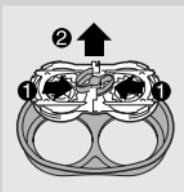
**3** Чтобы удалить крепёжную рамку, нажав с двух сторон к центру на центральную пружину (1), и снимите крепёжную рамку с бритвенного блока (2).
