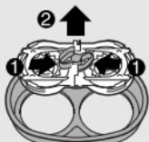
**3** Kinnitusraami eemaldamiseks lükake keskmise vedru otsi teineteise poole (1) ja tõstke kinnitusraam pardlipeast (2) välja.
