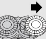
**3** Aby zdjąć element zabezpieczający, ściśnij boki środkowej sprężyny (1) i wyciągnij element zabezpieczający z elementu golącego (2).
