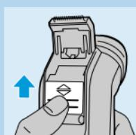
El cortapatillas se puede activar con la afeitadora en marcha.
