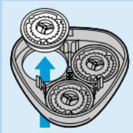
**3** Faites tourner la molette dans le sens contraire des aiguilles d'une montre et enlevez le flasque de retenue.
