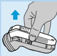
Ne raccordez plus l'appareil à la tension du réseau une fois que le accumulateur ont été enlevés.
