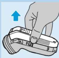
A máquina de barbear não deverá ser ligada novamente à corrente depois de lhe ser retirada a bateria.
