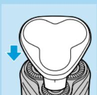
Sostituire le testine di rasatura (mod. HQ4 Micro Action) ogni 2 anni per ottenere sempre risultati ottimali.
