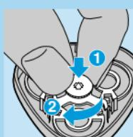
**7** Rimontate il blocco di rasatura riponendo il telaietto di fissaggio. Premete la rotella e ruotate in senso orario.
