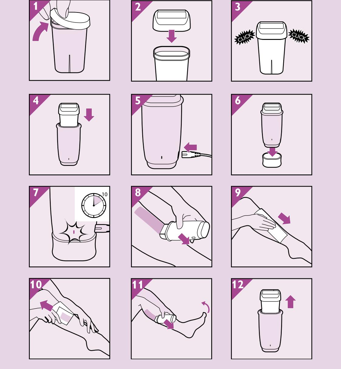
6 Nach ca. 10 Minuten ist die Aufheizphase beendet. Hat das Wachs die erforderliche Temperatur erreicht, blinkt die Kontroll-Lampe grün (Abb. 7). Das Gerät ist nun betriebsbereit.
