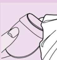
**4** Sperite hladilni nastavek in zaščitni etui pod tekočo vodo in ju očistite z vlažno krpo.
