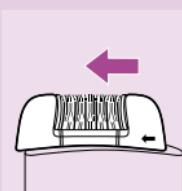
**6** Odstranite glavo z depilacijskimi diskami. Pritisnite rebrasti del in v smeri puščice potisnite depilacijsko glavo z aparata.
