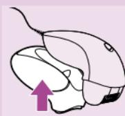
**3** Установите на прибор устройство охлаждения кожи в защитном футляре.
