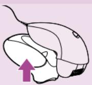
**2** Установите устройство охлаждения на прибор.
